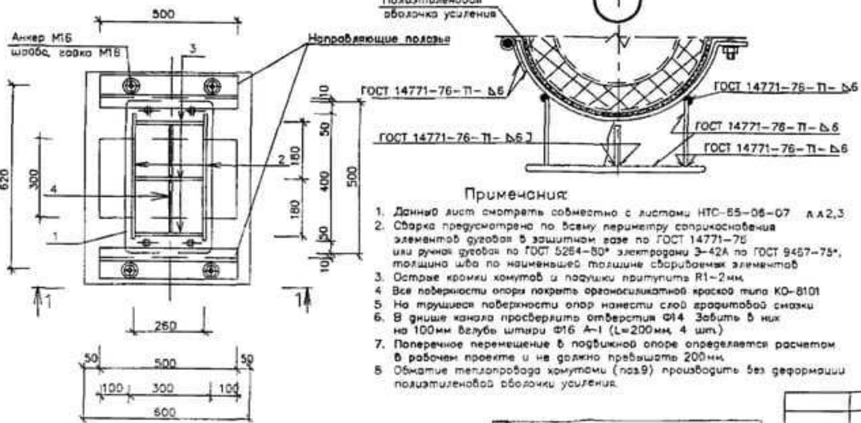
План крепления подвижной опоры
